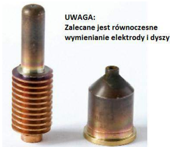
Rys.4 Zużyte dysze i elektrody powinny wymieniane jednocześnie
